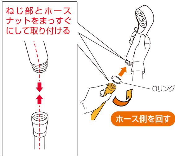
※斜めに入れるとねじ部が破損します。
