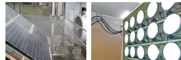
左:超大型台風並みの実耐風試験※1を実施 右:自然環境の中でも過酷な条件を再現した耐久性試験装置 ※1.写真はケイミュー株式会社伊賀事業所内での試験風景です。試験実施機関: パナソニック株式会社エレクトリックワークス社
