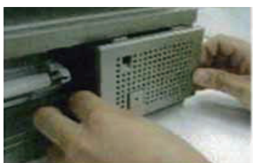
④インターホンパネルの側面から 手を添えてインターホンパネル をポストから引き出し、信号線 配線(2本または3本)を外す。
