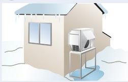
霜取り運転によって溶かされた霜は、ドレン水となって、ヒートポンプユニットの底面にあるドレン穴から排出。
