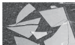
■通常ガラスの破損状態
