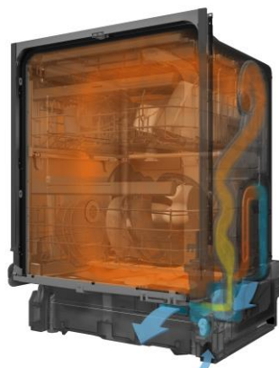
ヒーター乾燥からケコミ排気のイメージ
