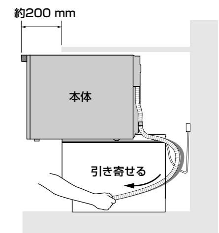
**4** 本体前面左右のフランジ部（樹脂製）が収納キャビネットの側板の前面木口に当たるまで、本体を押し込む。
