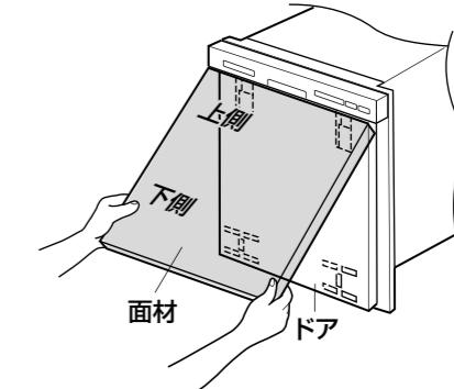
**3** ドアを少し引き出し、面材を押し上げた状態で左右の穴から⊕ドライバーで締め付ける。（面材の傾きに注意）
