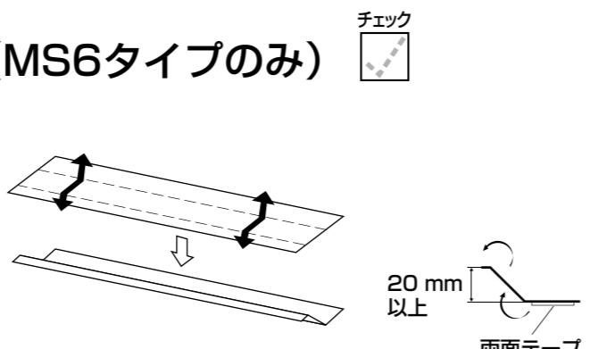
2 本体天面にある段押し部にフィラー後端を合わせ、左右均等になるように貼り付ける。
