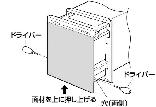
**4** 面材が確実に固定され、外れないことを確認する。
