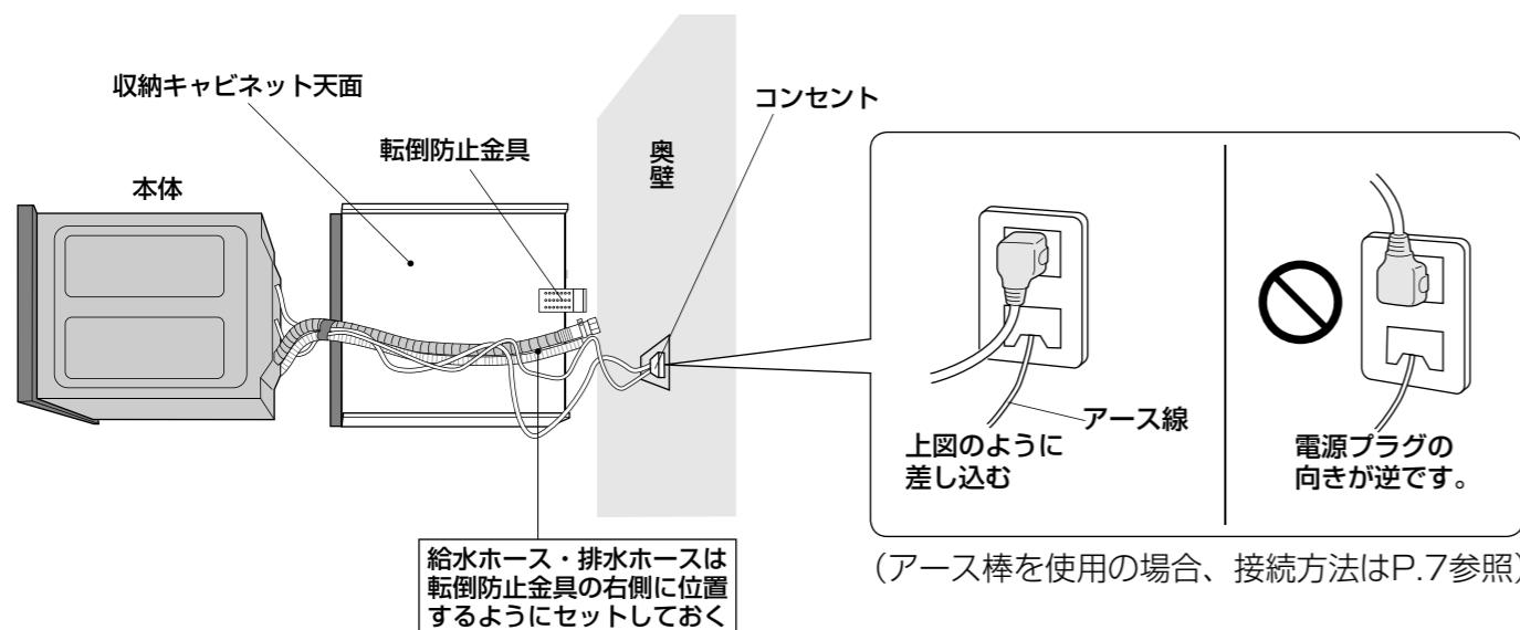
1 電圧が100 Vであることを確認してから、埋込みコンセントに電源プラグを差し込む。
