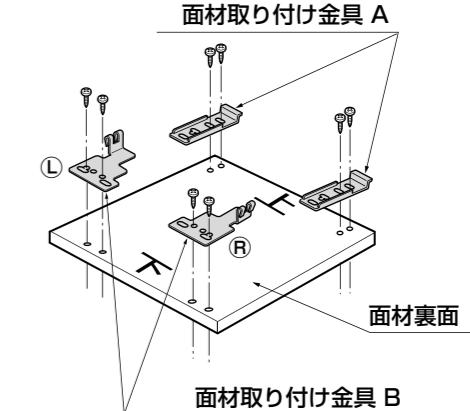
**2** 面材裏面の取り付け金具をドアの穴位置に合わせ、上側、下側の順でドアにはめ込む。
