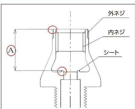
計測するA寸法は「外ネジの上部」から「シートのふくらみの上端」までです。
