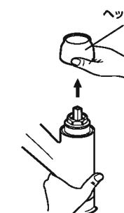
ヘッドパーツカバーを手で持ち回しながら上に持ち上げるようにして取り外す。
