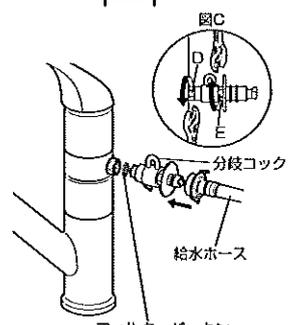
分岐コックの開閉操作(ひらく・とじる)をして締め付けた部分かゆるまないか確認してください。
