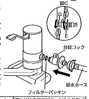
(注)分岐コックの開閉操作(ひらく・とじる)をして錆付けられた部分がゆるまないか確認してください。
