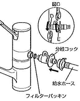
(!) 分岐コックの開閉操作(ひらく・とじる)をして挿み付けた部分がゆるまないか確認してください。
