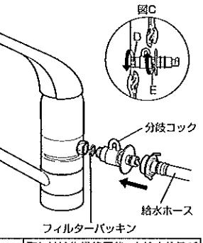
! 分岐コックの開閉操作(ひらく・とじる)
