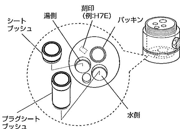
手順2: 抜き取ったシートブッシュ(短い方)を刻印側(湯)に差し込む。プラ
