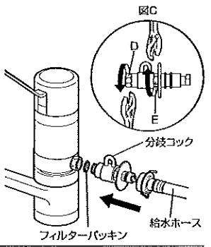
!(分岐コックの開閉操作(ひらく・とじる)をして締め付けた部分がゆるまないか確認してください。)
