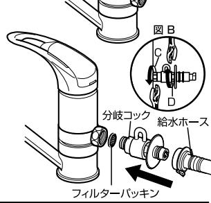
分岐コックの開閉操作(ひらく・とじる)をして締め付けた部分がゆるまないか確認してください。
