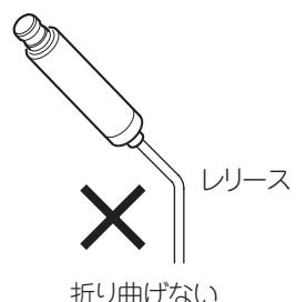
⑤レリース先端の保護先キャップを取りはずし、メカボックスを取り付ける。
