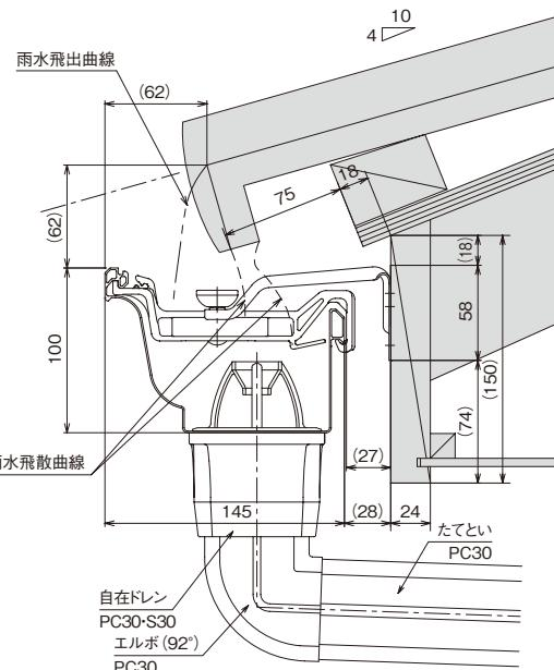
\*屋根瓦と雨といの組み合わせによっては、雨といが水を受けきれない場合があります。施工前後に受水確認をお願いします。
