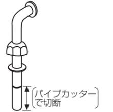
分岐金具への差込代は約10mmを必ず確保する。
