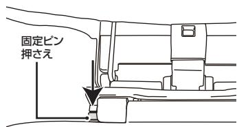
②固定ピン押さえを押しながら固定ピンを左へスライドしてはずしてください。
