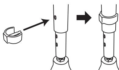
重なったパイプ穴に高さ調整脚ストッパーを差し入れてください。高さ調整脚が固定されます。
