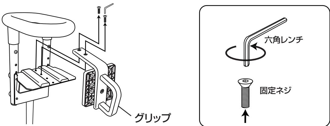
④ P9 ①で確認した位置に移動アームを調整し、固定ネジで締めてください。
