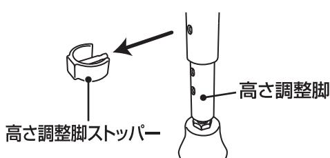
高さ調整脚ストッパーをはずし、高さ調整脚をいったん床面に接地させます。
