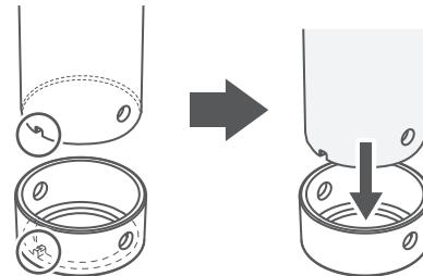
高さ調整脚を誤った向きで取り付けると、高さ調整ができなくなったり、高さ調整脚が固定できず、本体が不安定な状態となります
