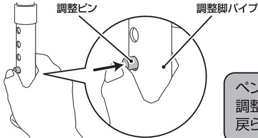
ペンなどの細い工具で強く押し込むと調整ピンがパイプ内部に入り込み戻らなくなります。
