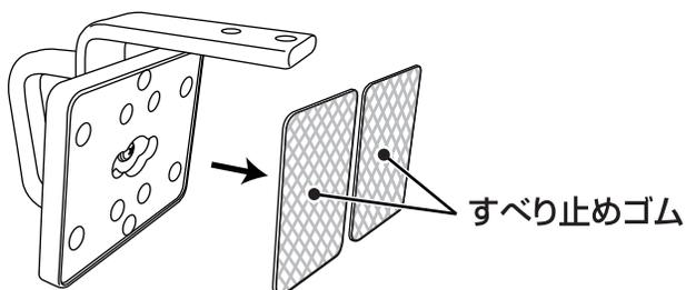
**3** 固定プレートの上下にあいている穴に、プラスドライバーを通して、グリップ固定ネジをはずしてください。
