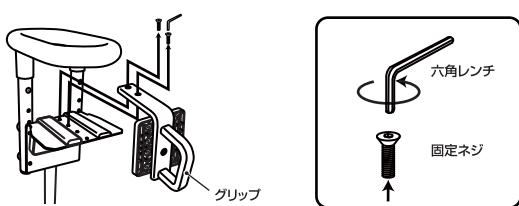
④ ①で確認した位置に移動アームを調整し、固定ネジで締めてください。
