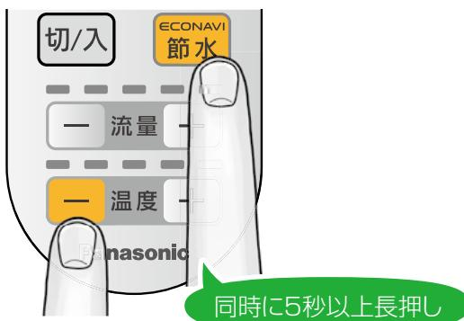
6 溫度表示ランプが、調整したレベルの位置で約2秒点滅した後、消灯したことを確認する
