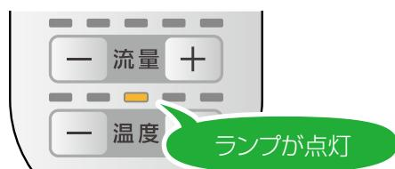
4 溫度調整ボタンを押して、節水センサーの感度を調整する
