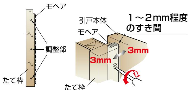
マイナスドライバー使用して、調整部3か所を回転させて調整する
