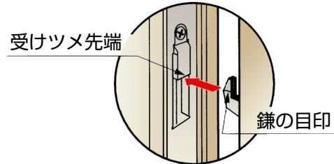
鎌の目印の位置に、受けツメ先端がくるように高さ調整ねじを調整する
