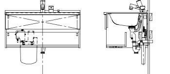
※注意 タッチレス水栓をご採用の場合、シャワーホース用 水受けタンクが上図のように取り付けます。
