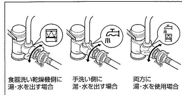
**!** 食器洗い乾燥機を運転するときはかならずレバーハンドルと分岐コックレバーを操作して、通水してください。
