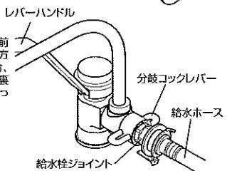
(!) 分岐コックの開閉操作(ひらく・とじる)をして締め付いた部分がゆるまないか確認してください。
