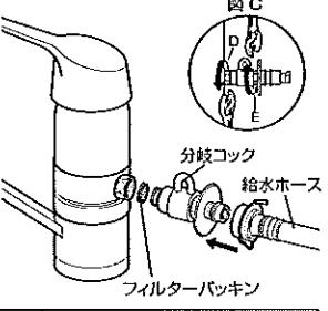
!(分岐コックの開閉操作(ひらく・とじる)
