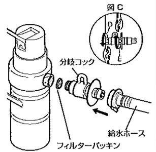
分岐コックの開閉操作(ひらく・とじる)をして締め付けた部分がゆるまないか確認してください。
