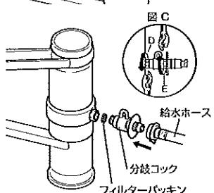
!(注) 分岐コックの開閉操作(ひらく・とじる)をして持付けた部分がゆるまないか確認してください。
