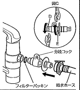
●分岐コックの開閉操作(ひらく・とじる)をして締め付けた部分がゆるまないを確認してください。
