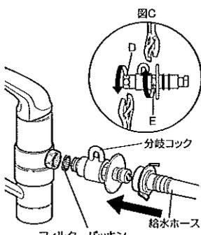
分岐コックの開閉操作(ひらく・とじる)
