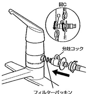
分岐コックの開閉操作(ひらく・とじる)をして締め付けた部分がゆるまないか確認してください。
