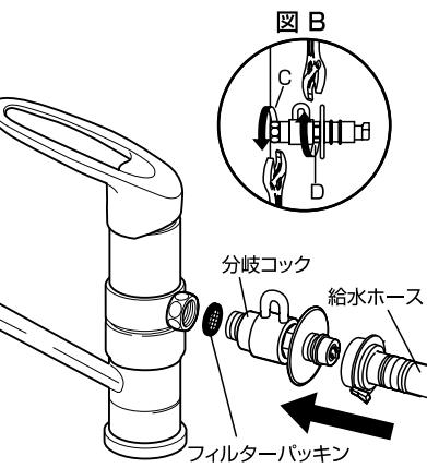
(お願い:分岐コックの開閉操作(ひらく・とじる)をして締め付けた部分がゆるまないか確認してください。)
