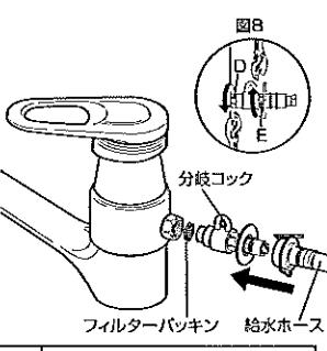
分岐コックの開閉操作(ひらく・とじる)
