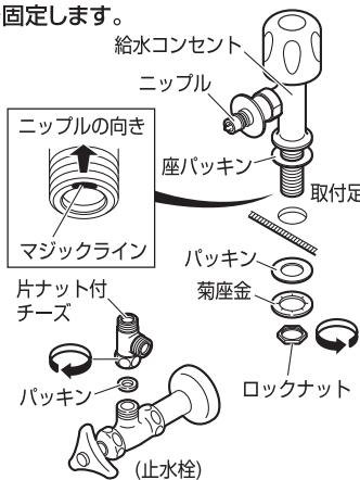
4 給水コンセントと片ナット付チーズを、ブレードホースで接続します。
