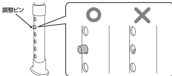
調整ピンが隠れて見えない場合があります。その場合は、調整脚パイプを引っ張って取りはずし、調整ピンの位置を確認後に取り付け直してください。
